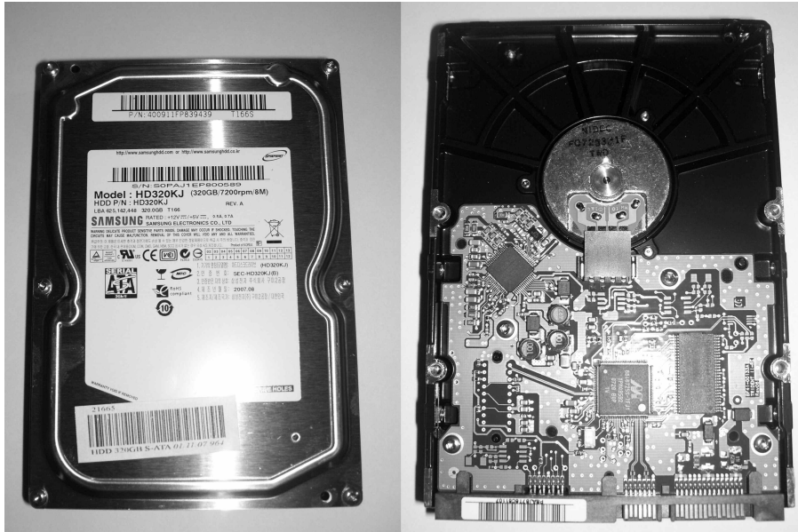
Disco. Disco SATA de 7200 revoluciones y 8 megas de caché a punto de ser particionado para hacer una estación/server multiboot.
